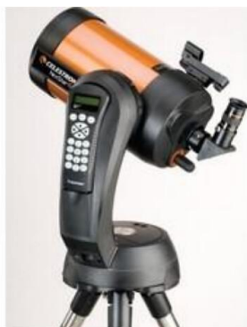
Hình 24. Một kính thiên văn Schmidt-Cassegrain với chân đế độ cao - phương vị, động cơ, và máy tính điều khiển Go-to. Credit: OneMinuteAstronomer.
